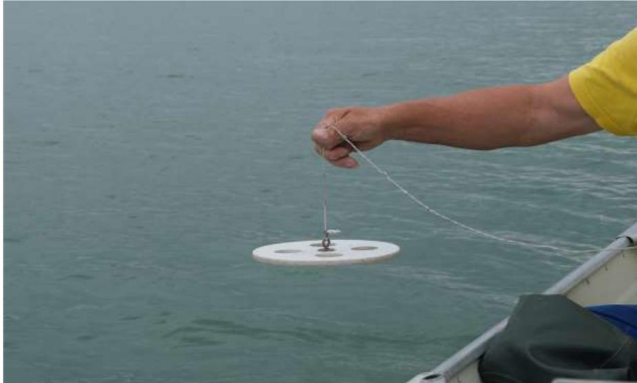
Abbildung 2: Messung der Sichttiefe mittels einer Secchi-Scheibe, die an einer markierten Leine so weit in den See hinuntergelassen wird, bis sie nicht mehr sichtbar ist.
